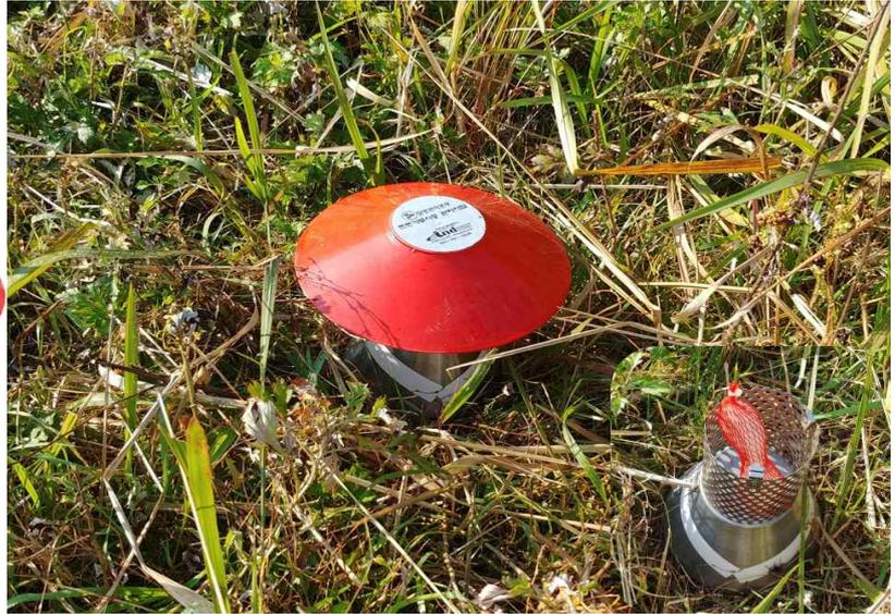
감시사업에 활용되는 털진드기 채집기(왼쪽) 및 설치 사진(오른쪽)
