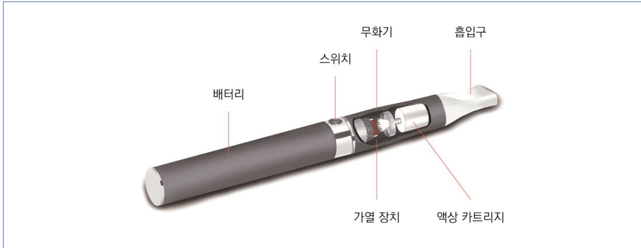
그림 1-1. 액상형 전자담배 내부 구조도
